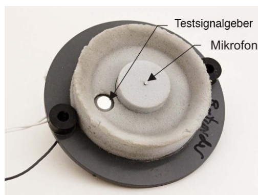
Abbildung 1 Mikrofonenscheibe des Batcorders aus einer PVC Grundplatte (dunkelgrau) und einem Basotect® Aufsatz (hellgrauer Schaumstoff).
